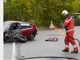
Mettere in sicurezza il luogo dell'incidente. Pre-disporre una triplice protezione antincendio (acqua, schiuma, polvere).
