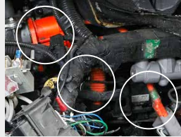
I connettori o i cavi arancioni, le diciture riconoscibili sul veicolo e i connettori di ricarica indicano che si tratta di un veicolo elettrico o ibrido.
