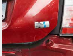
I connettori o i cavi arancioni, le diciture riconoscibili sul veicolo e i connettori di ricarica indicano che si tratta di un veicolo elettrico o ibrido.
